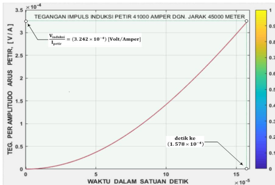
Gambar 6. Induksi petir 41 kA dgn titik sambaran sejauh 45 km dari Posisi Tangki 36 T-102 (Isi Peralite)
