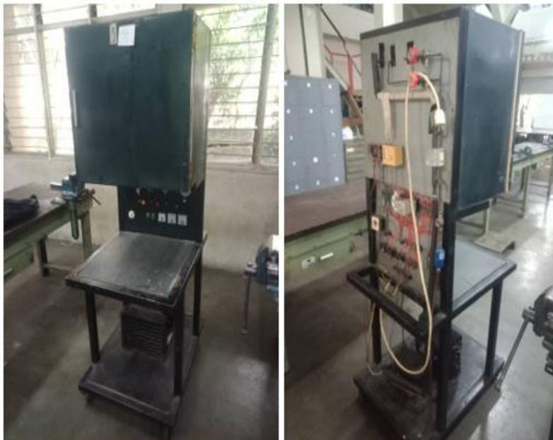
**Gambar 6.** Mesin *trainer* refrigerasi sederhana
