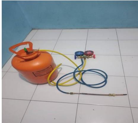
**Gambar 5.** Foto alat uji coba kebocoran refrigeran
