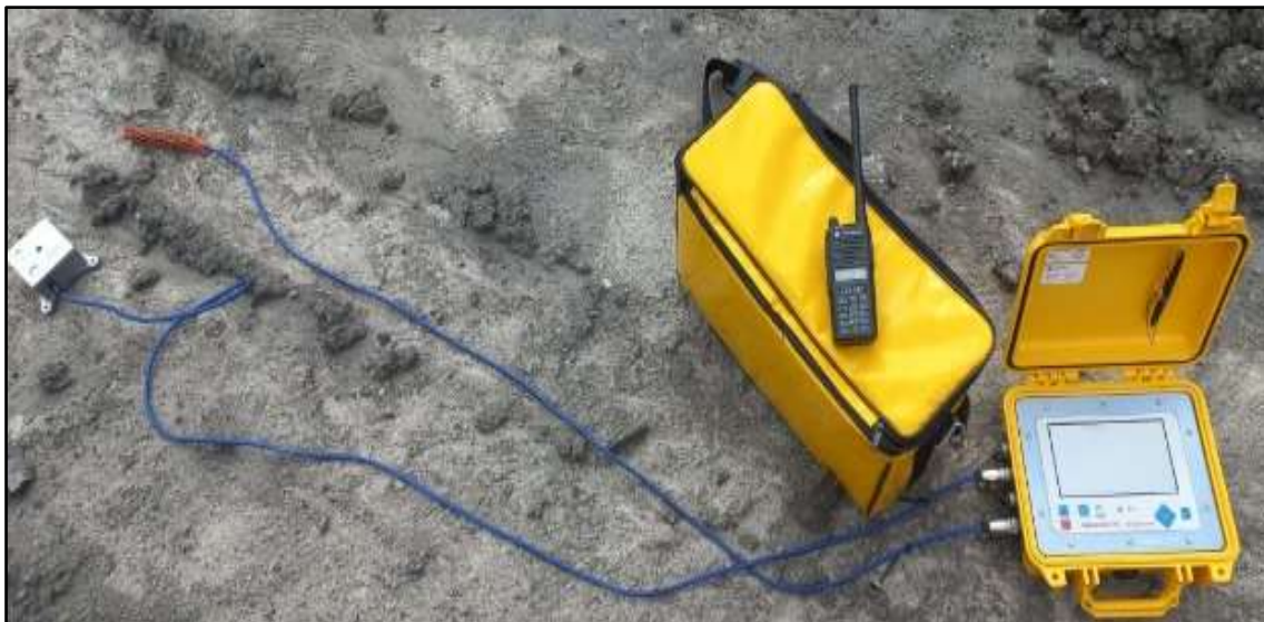
Gambar 2. Geophone dan Microphone yang dipasang pada Vibration Meter
