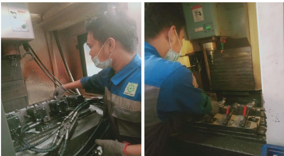
Gambar 6. Pengambilan Handle pada jig dan Pengecekan Tools End mill
