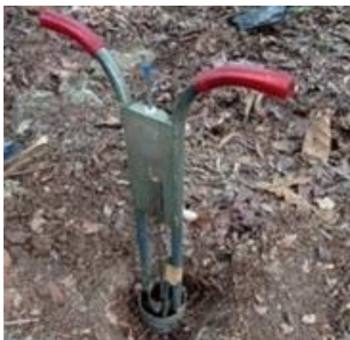
Gambar 4. Pengukuran dengan menggunakan Turf-tec infiltrometer di lokasi penelitian [13]
