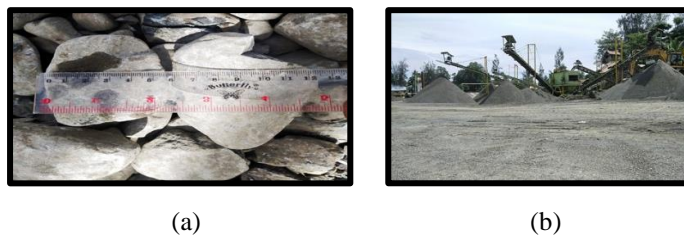
Gambar 4. (a) Ukuran umpan masuk/ukuran material, (b) hasil masing-masing fraksi
