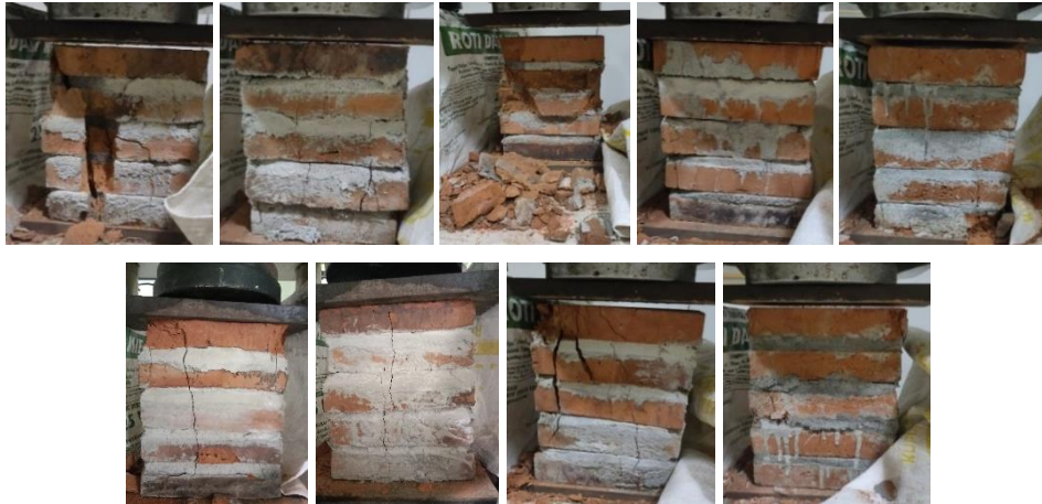
Gambar 7. Kondisi masonry prism setelah pengujian kuat tekan
