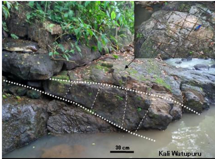
Gambar 12. Geometri lensa batupasir Nanggulan yang telah terkekarkan secara vertical. Pola kekar gerus (shear joints) yang dijumpai di bagian atas dari geometri lensa tersebut (Kali Watupuru).
