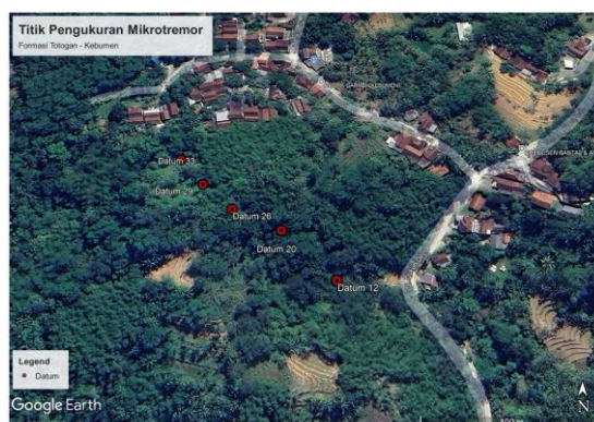
Gambar 5. Distribusi titik pengukuran mikrotremor pada Formasi Totogan, Desa Totogan. Titik merah merupakan titik pengukuran mikrotremor (Google Earth dan data lapangan)
