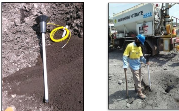
Gambar 2. Penggunaan Metode air deck di lapangan
