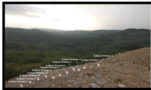
Gambar 7. Lokasi Penempatan Prisma untuk Pemantauan
